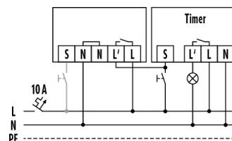
Raccordement sur minuterie et commande optionnelle par poussoir
