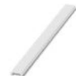
Repérage ZB, plat, Rubans, blanc, vierge, repérable avec : PLOTMARK, CMS-P1-PLOTTER, type de montage: encliquetage dans la rainure de repérage plate, pour bloc de jonction au pas de : 16 mm, surface utile: 16,25 x 10,5 mm, Nombre d'étiquettes: 50
