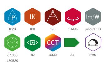
Ruban LED haute performance avec 120 SMD2835 LED par mètre. Voltage de connexion 24VDC, réglable avec variateur PWM. Convient aux applications intérieures IP20, rouleau de 5m, puissance 7,6W par mètre, peut être raccourcie tous les 5 cm. Câble de connexion de 30 cm des deux côtés. Connectez maximum 15m en série avec l'alimentation d'un coté. Application: éclairage d'ambiance ou de niche.
