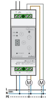
Ce récepteur à 2 canaux pour montage sur rail DIN se commande sans fil via la radiofréquence. Il est doté de deux sorties contenant chacune deux inverseurs de 6 A/230 V ainsi que d'une connexion pour une antenne externe (410-00359). Vous utilisez le module pour ouvrir, fermer ou arrêter les volets et stores vénitiens. La fonction terrasse permet de verrouiller la direction de la fermeture d'une ou de plusieurs sorties, évitant ainsi un verrouillage involontaire.
