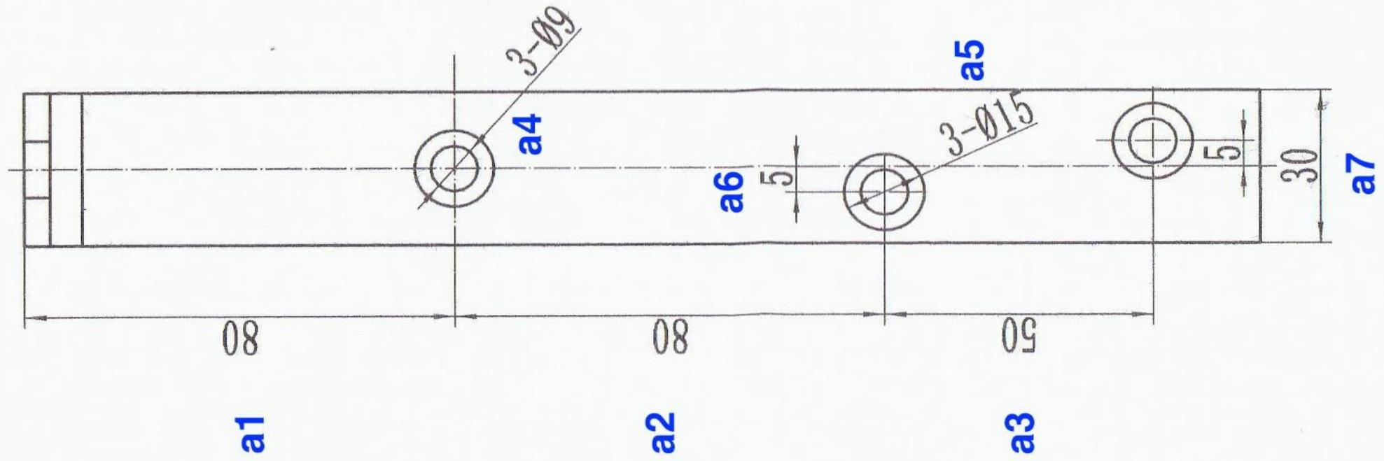
Crochet toit en ardoise RVS
