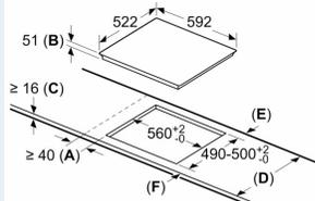
**A:** Distance minimum entre la découpe de la plaque de cuisson et le mur.
