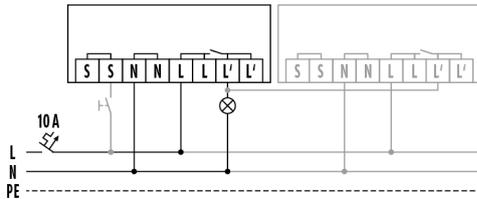
Raccordement avec commande optionnelle par poussoir. Mise en parallèle de 10 appareils au maximum.
