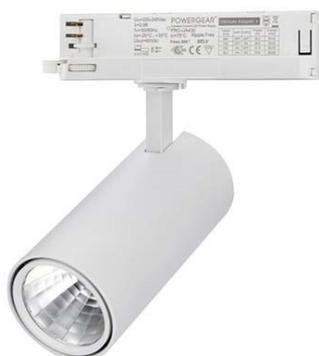
Tracklight réglable pour rail triphasé universel Eutrack. Boîtier blanc RAL9016 équipé avec puce LED Citizen à haut rendu des couleurs CRI90 et réflecteur Alanod de 30° avec un rendement de 97%. Adaptateur de rail Powergear avec driver Osram flicker free intégré, non dimmable. Durée de vie 50.000 heures L80B20, garantie 5 ans.
