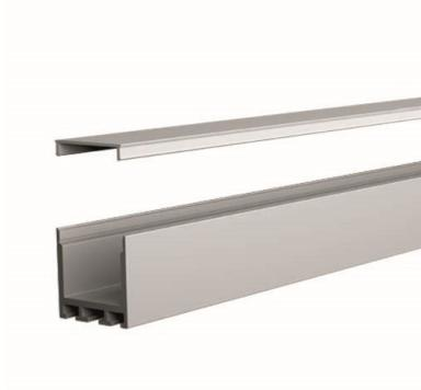
Profilé LED SL FLAT 25x25mm en aluminium anodisé AL6063 longueur 3 mètres. Kit complet avec profil LED 2m et diffuseur blanc mat en PC, 2 embouts sans entrée de câble, 2 embouts avec entrée de câble et 4 supports de fixation invisibles en acier inoxydable L304 dans un tube en carton pratique et robuste. La série SL Flat se distingue par une finition élégante sans rainures, un diffuseur blanc mat aussi large que le profil et une capacité de refroidissement élevée.
