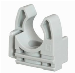
Lyre pour tube de 5/8" (CEI 16) - polyamide - gris - diamètre minimum 15 mm - diamètre maximum 16 mm - fixation des tubes par simple enclipsage
