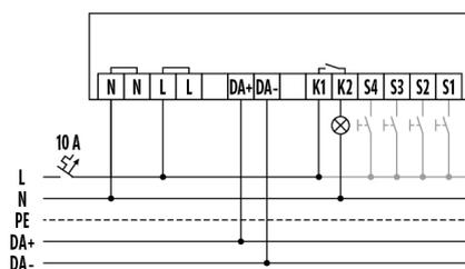
Raccordement avec commande optionnelle par poussoirs.
