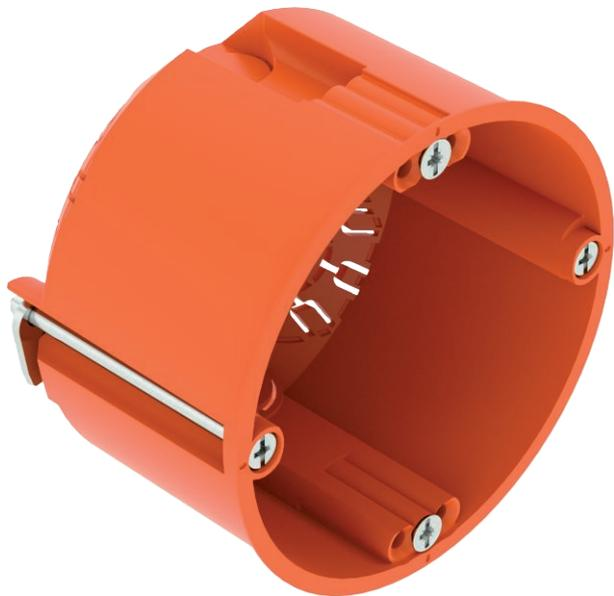
Boîtier d'appareillage pour mur creux à utiliser dans des murs creux d'une profondeur de pose d'au moins 47 mm et une épaisseur de panneau de 5 à 40 mm.
