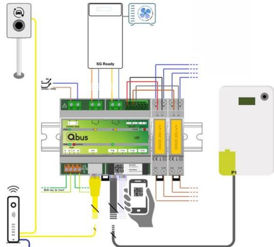
Figure 3 Exemple de schéma de raccordement
