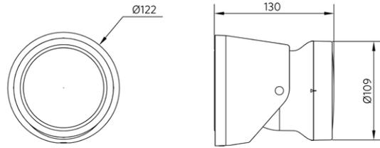
560006000900 - LEDSmart-Sensor IP65-Base-Module
