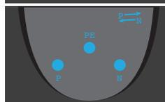
Inversion de la phase et du conducteur neutre. **Mesure impossible.**
