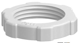
Contre-écrou selon la norme DIN 46320, avec filetage PG selon la norme DIN 40430. Conseil : contre-écrou en polystyrène, à serrer modérément en raison du risque de formation de fissures dues à la contrainte !
