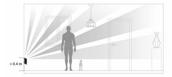
L'emplacement du MotionProtect Curtain dépend de la distance au hub et des obstacles entre les appareils qui peuvent gêner le signal radio : murs, sols, objets massifs dans la pièce.
