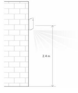
L'installation du détecteur à une hauteur différente de celle recommandée rétrécit la zone de détection et peut affecter la qualité de la détection de mouvement.
